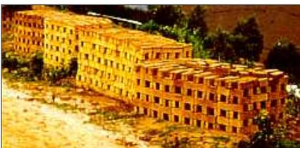
Relativement sèches, les briques sont empilées par piles de 1000 briques et stockées jusqu'au moment de la cuisson.
