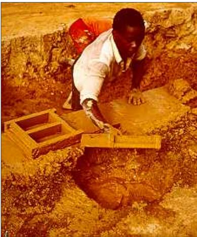
Pour fabriquer les briques à cuire, on utilise de l'eau et une terre argileuse, légèrement collante. Un trou est creusé dans le sol et de l'eau y est déversée.
